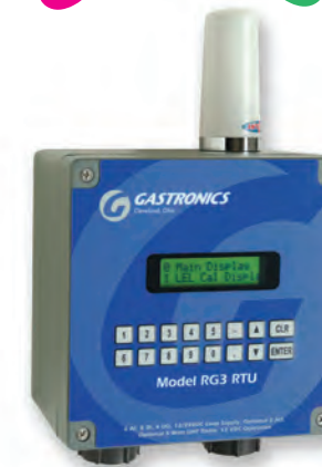
RG3 RTU Combina la detección inalámbrica de gases con controles y monitoreo inalámbricos. Incluye 6 entradas analógicas, 8 entradas digitales, 4 salidas de relevadores y RS232/485 (Modbus-RTU)
