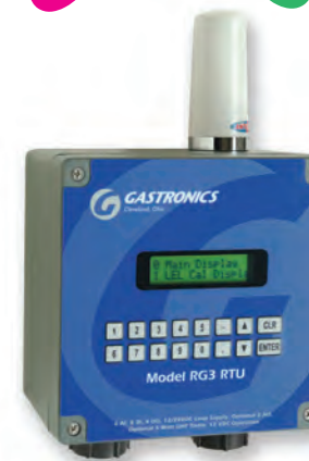
RG3 RTU Gabungkan Pengesanan Gas Wayarles dengan Pengawasan dan Kawalan Wayarles. Mempunyai 6 input analog, 8 input digital, 4 output geganti dan RS232/485 (Modbus-RTU)
